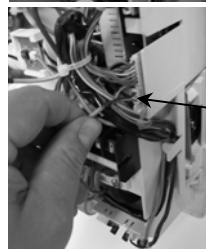
Montage des Steckers der Kabel- FB
