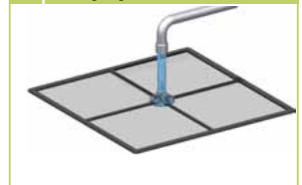
4 Reinigung mit lauwarmen Wasser
