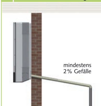
11 Gefälle der Kondensatleitung
