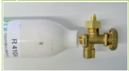
11 Festschrauben von Füllnippel
