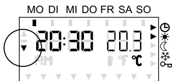
Anzeige bei geschaltetem Ausgang „Kühlen“
