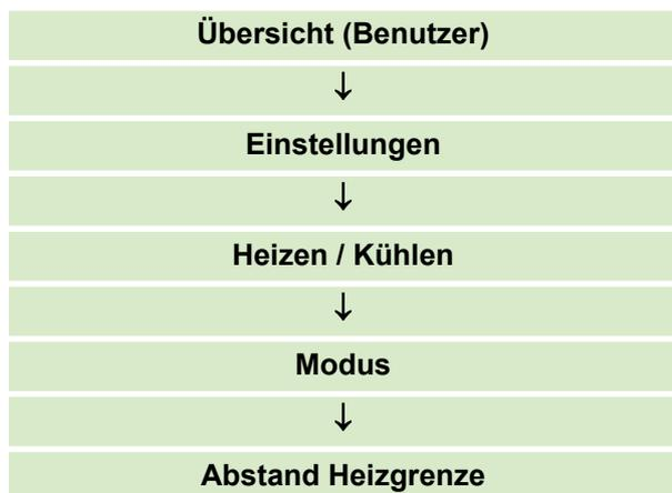
Der Wert 0.0 K bedeutet, dass die Wärmepumpe erst in den Sommerbetrieb schaltet wenn die eingestellte Raumsolltemperatur von z.B. 20 °C am Außenfühler erreicht hat. Beachten Sie bitte das Diagramm in Abb. 9 als Hinweis welcher Wert hier eingestellt werden sollte.
