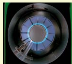
Effectieve verbranding door de Multi-Point-Injectie
