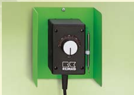
Thermostaat natte cel, type RT-5, stekkerklaar gering schakelverschil, beschermingsgraad IP 54, incl. 10 m kabel voor vochtige ruimte, aansluitstek- ker beschermingsinrichting van gelakt plaatstaal
