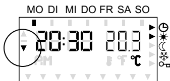
Anzeige bei geschaltetem Ausgang „Kühlen“
