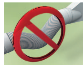
Fig. 7 Le tuyau d'air d'évacuation doit monter en permanence
