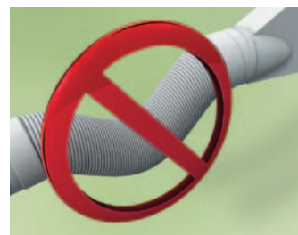
Afb. 7 Uitlaatslang continu stijgend aanbrengen
