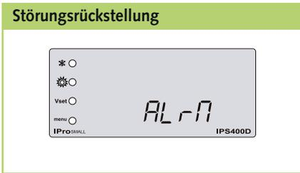
Um das Gerät vor Schäden zu schützen, überprüft der Regler die für die Sicherheit des Gerätes relevanten Bauteile auf Temperatur, Druck, Konfiguration usw. Über das Anzeigedisplay des Reglers wird, durch eine Buchstabenfolge, eine codierte Fehlermeldung als Störungscode angezeigt. Diesem Code kann die Ursache zugeordnet werden (Siehe Tabelle "Störanzeige durch Code").
