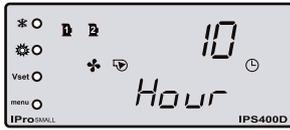
Vor der ersten Bedienung des Gerätes oder bei der Meldung „rtC“ sind die Zeiten einzustellen. Durch längeres Betätigen der Taste „menu“ kann die Datums- und Uhrzeiteinstellung innerhalb der folgenden Grenzen vorgenommen werden:
