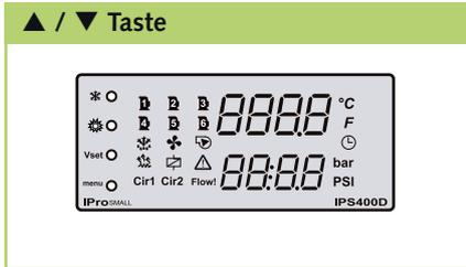
Aktivieren bzw. deaktivieren Sie das Gerät, indem die Spannungsversorgung zum Gerät freigeschaltet wird. Der Regler durchläuft einen Selbsttest und zeigt dann die Betriebsbereitschaft, durch Blinken der LED 1 unterhalb der Anzeige, an.
