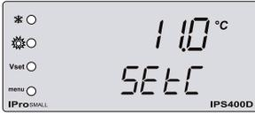
Über die Taste SET kann während des Standby- oder Kühlmodus der eingestellte Wert angezeigt werden. Zur Änderung des eingestellten Wertes ist die Taste SET ca. 2 Sekunden zu drücken. Die Anzeige beginnt zu blinken. Mit den Tasten ▲ oder ▼ kann der Wert innerhalb der werkseitig festgelegten Grenzen (St 02 + St 03) eingestellt werden.
