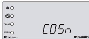
Im Untermenü „COSn“ können die Kompressorstarts abgefragt werden. Durch Rotation werden die Kompressoren mit den geringsten Starts zuerst angefordert.
