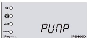
Im Untermenü „PUMP“ können einzelne Kompressoren z.B. für Wartungszwecke gesperrt oder freigegeben werden.
