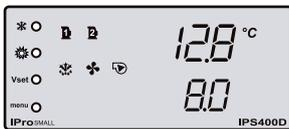
In der normalen Anzeige wird die aktuelle Medieneintrittstemperatur und die Mediaustrittstemperatur angezeigt.
