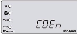
Im Untermenü „COEn“ können einzelne Kompressoren z.B. für Wartungszwecke gesperrt oder freigegeben werden.
