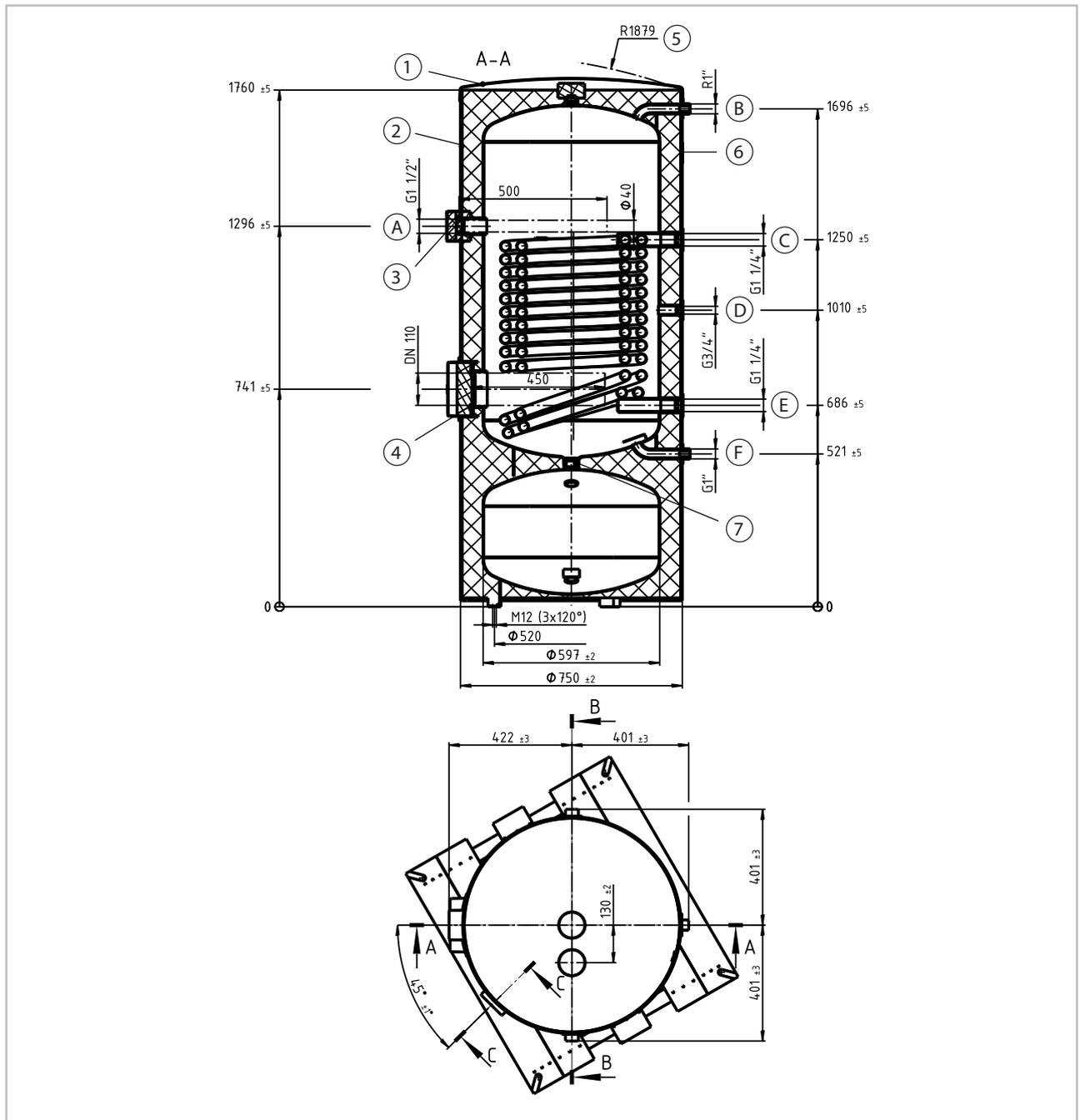
Abb. 1: Geräteabmessungen (Alle Angaben in mm)
