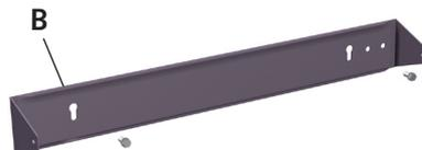
2. Fixer l'équerre de montage B à l'horizontale et de manière sécurisée sur un mur porteur en matériau non inflammable et en respectant les distances de sécurité requises.
