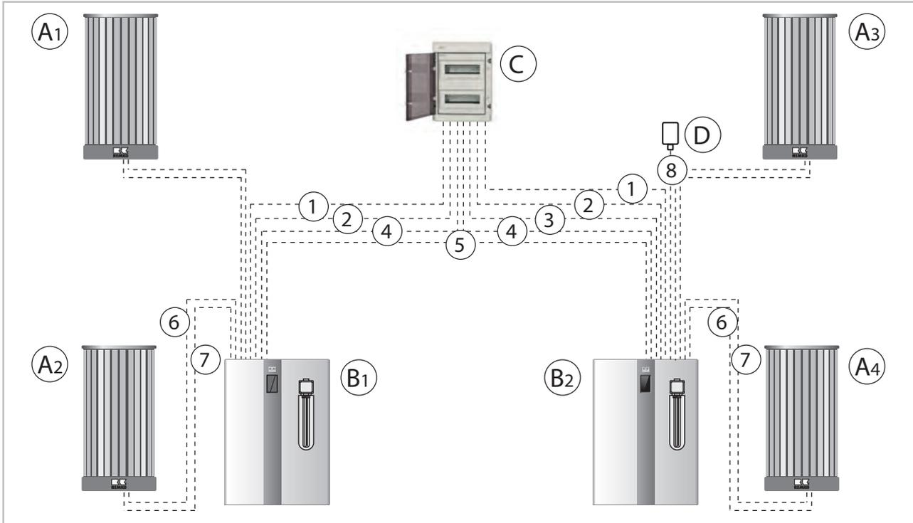
Abb. 18: Übersicht Elektrischer Anschluss HTS 200 Duo
