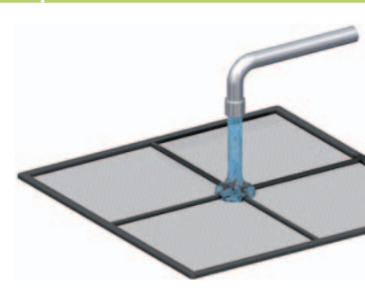
6 Reinigung mit lauwarmen Wasser
