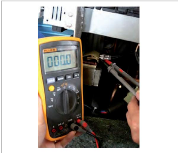
Fig. 43: Mesure du transformateur
