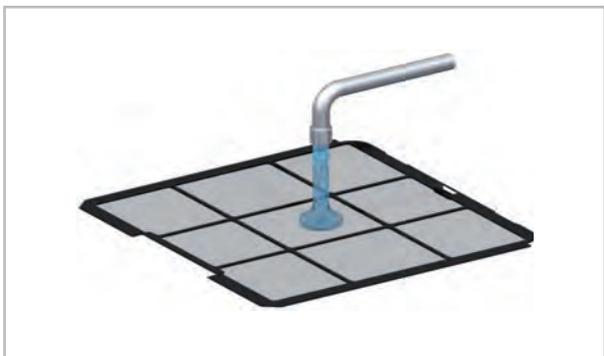
Fig. 49: Nettoyage avec l'eau tiède
