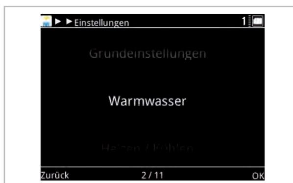
5. Drehen Sie am Drehknopf bis der Parameter "Hygiene Funktion" erscheint. Drücken Sie die "OK"-Taste um in diese Ebene zu gelangen.
