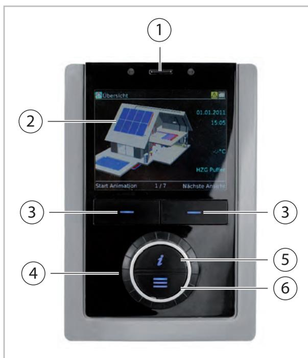
Abb. 1: Bedienelemente des Smart-Control
