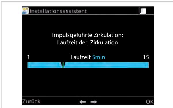
Abb. 45: Impulsgeführte Zirkulation - Laufzeit der Zirkulation wählen
