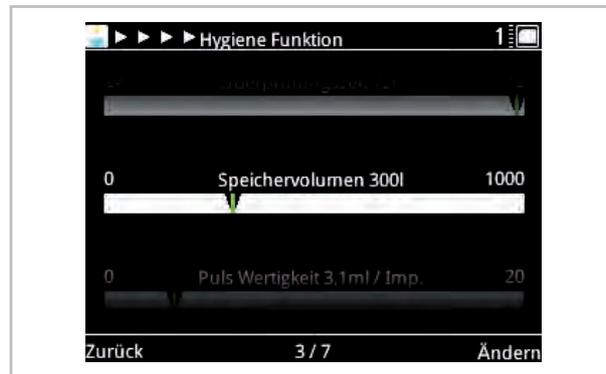
9. Nach erfolgter Einstellung erreichen Sie den nächsten Parameter "Puls Wertigkeit" über drehen des Drehknopfs.
