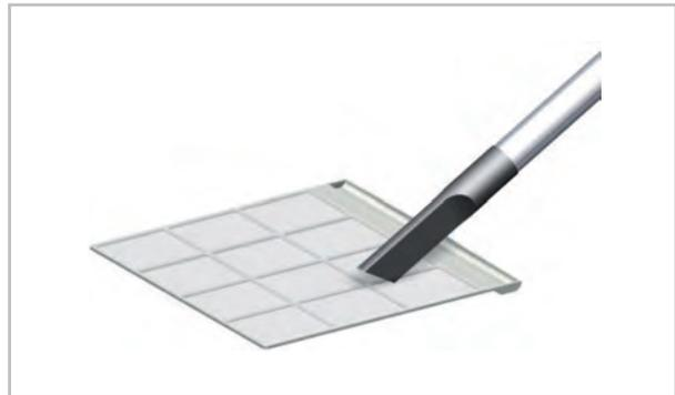
Abb. 20: Reinigung mit dem Staubsauger
