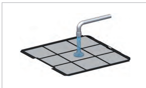
Fig. 21: Nettoyage avec l'eau tiède
