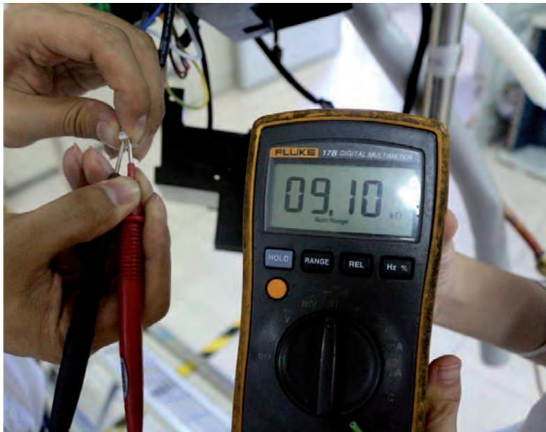
Abb. 53: Überprüfung der Sensoren
