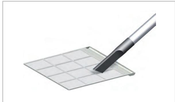
Abb. 55: Reinigung mit dem Staubsauger
