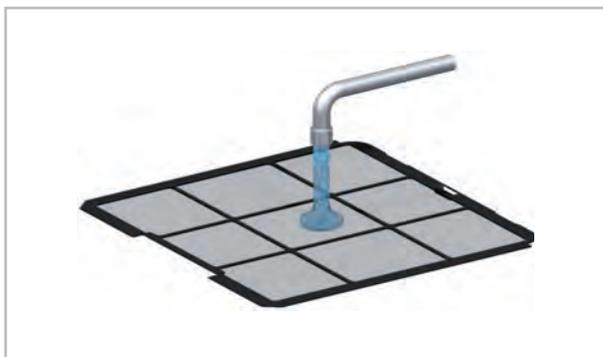
Fig. 23: Nettoyage avec l'eau tiède
