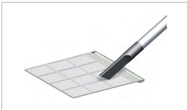
Fig. 22: Nettoyage avec l'aspirateur
