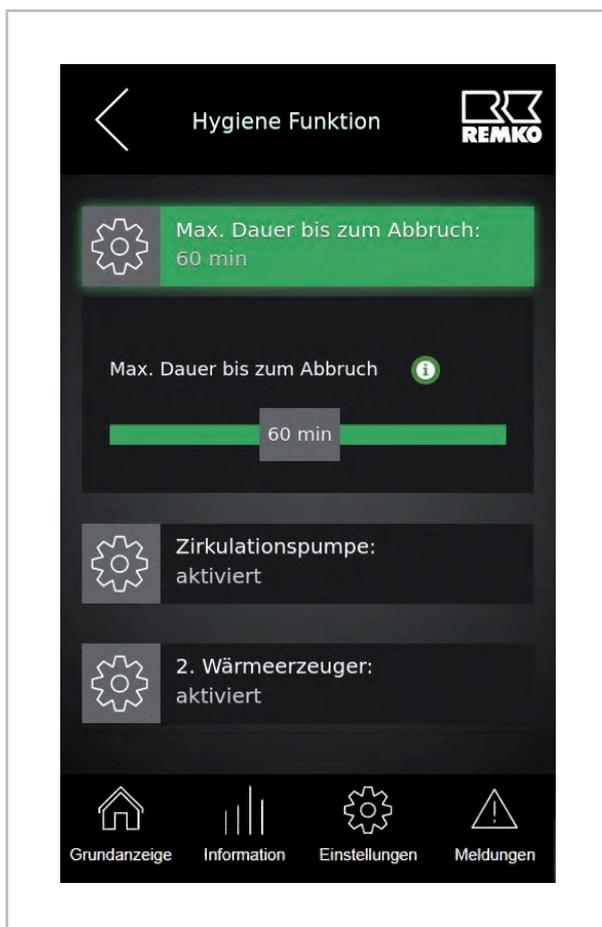
Nach erfolgter Einstellung erreichen Sie den nächsten Parameter "Einstellung der Zirkulationspumpe".
