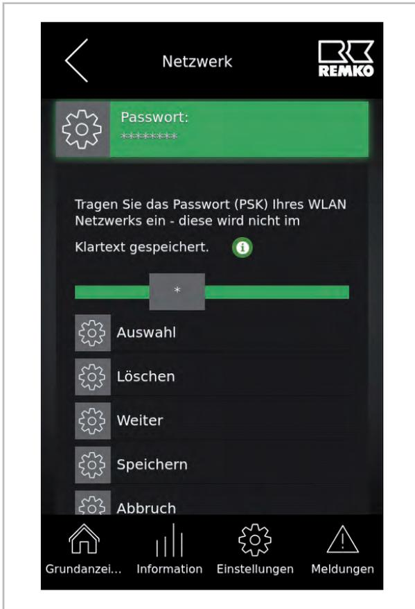
Wenn alle Parameter passend für Ihr WLAN Netzwerk hinterlegt worden sind, wird sich die Wärmepumpe mit Ihrem Netzwerk verbinden. Dies können Sie über den Parameter "Status" kontrollieren. Hier muss jetzt (wenn alle Daten passen) "verbunden" stehen. Um die Daten der Wärmepumpe auf einem Smartphone, Tablett oder Laptop sehen zu können, notieren Sie sich die IP-Adresse die hinter der Kennung "verbunden" steht.
