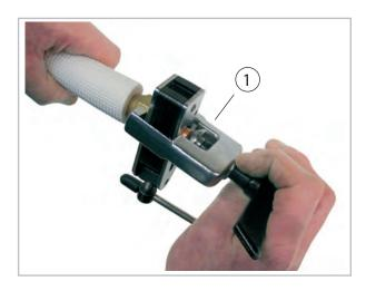
Fig. 38: Sertissage de la conduite de frigorigène1 : Dudgeonnière
