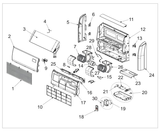
Fig. 57: Représentation de l'appareil RXT 525-685 DC IT
