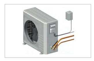
Fig. 45: Raccordement de l'unité extérieure
