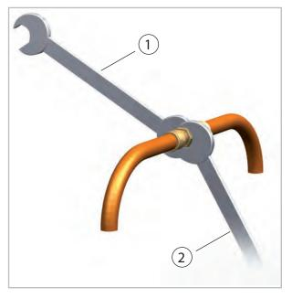
Fig. 40: Serrage des raccords vissés
