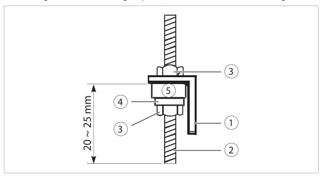
Fig. 30: Fixation d'unités avec tige filetée
