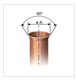
Fig. 39: Bord relevé de forme adéquate
