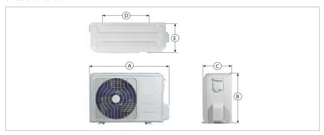
Fig. 1: Dimensions RXT 525-1405 DC AT (toutes les indications sont en mm)
