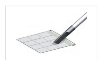
Fig. 55: Nettoyage avec l'aspirateur
