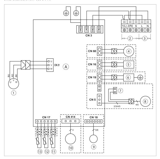
Fig. 50: Schéma de câblage électrique
