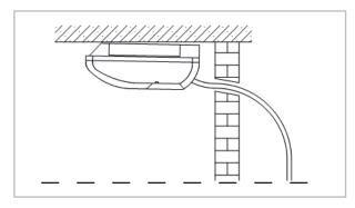
Fig. 43: Raccord pour condensat des unités intérieures au plafond
