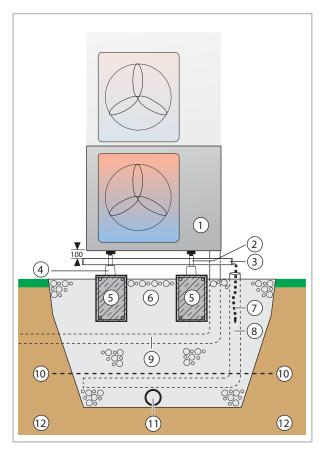
Fig. 41: Conduite de condensat, évacuation de condensat et fondations de bande (coupe)
