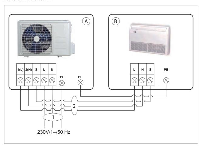
Fig. 46: Schéma de raccordement électrique
