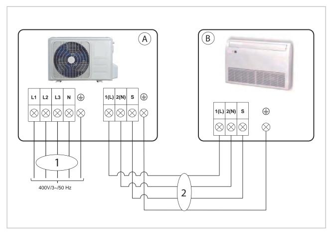
Fig. 47: Schéma de raccordement électrique RXT 1055 DC
