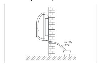
Fig. 42: Raccord pour condensat des unités intérieures au mur
