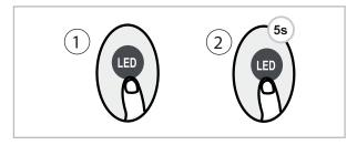
Fig. 16: Désactiver l'éclairage et les signaux sonores
