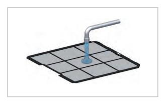
Fig. 56: Nettoyage avec l'eau tiède
