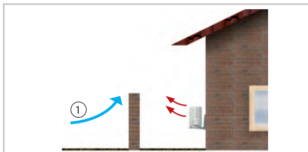
Fig. 6: Protection contre le vent / 1 : Neige
