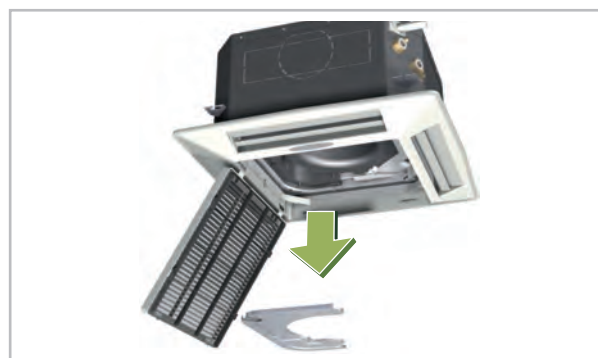
Fig. 35: Accès au coffret électrique
