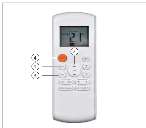
Fig. 10: Mode « Refroidissement », « Chauffage » et « Recirculation »
