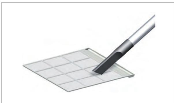
Fig. 48: Nettoyage avec l'aspirateur
