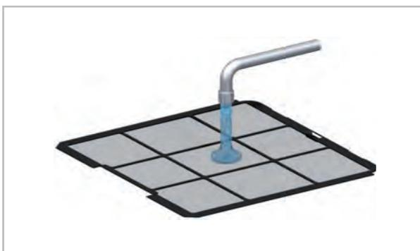
Fig. 39: Nettoyage avec l'eau tiède
