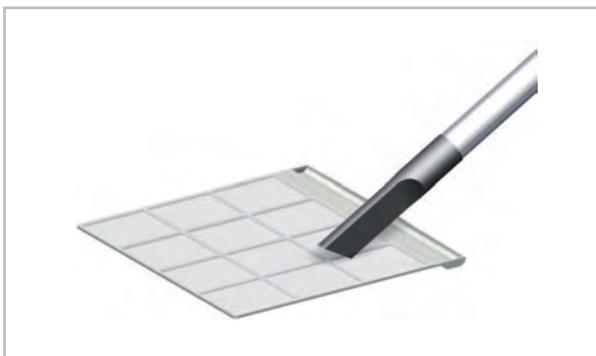
Fig. 38: Nettoyage avec l'aspirateur
