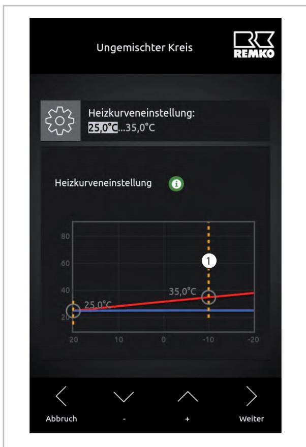
Abb. 9: Norm-Außentemperatur einstellen
