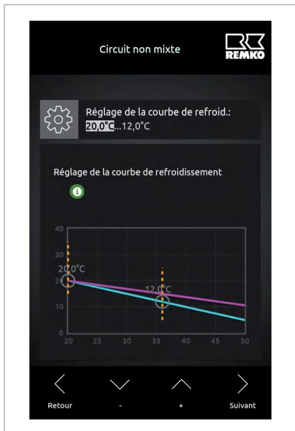
Fig. 12: Réglage de la valeur plancher
