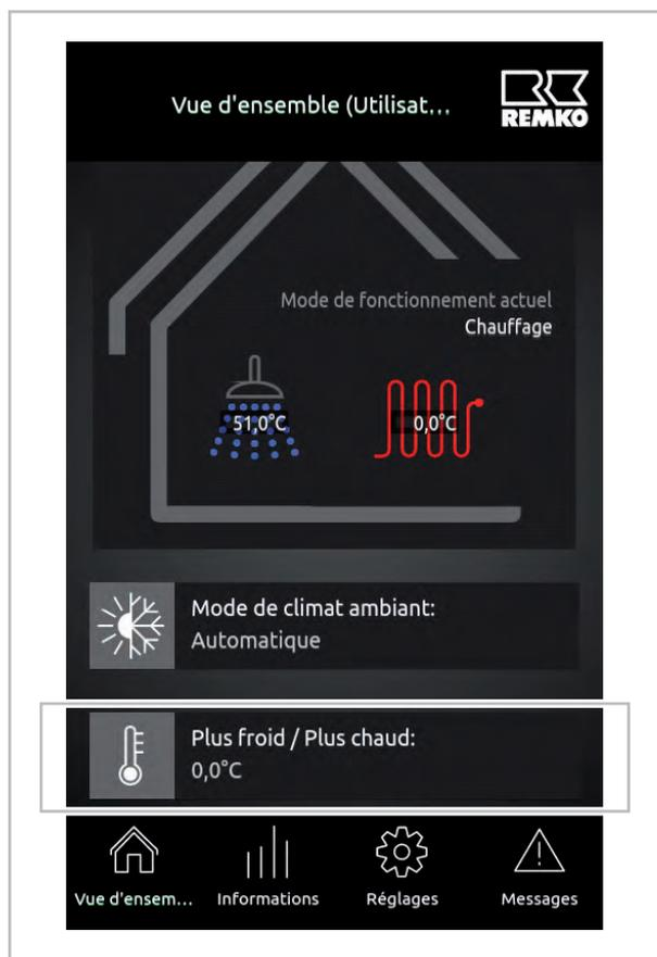
Fig. 18: Sélectionner l'option de menu « Plus froid/ plus chaud »
