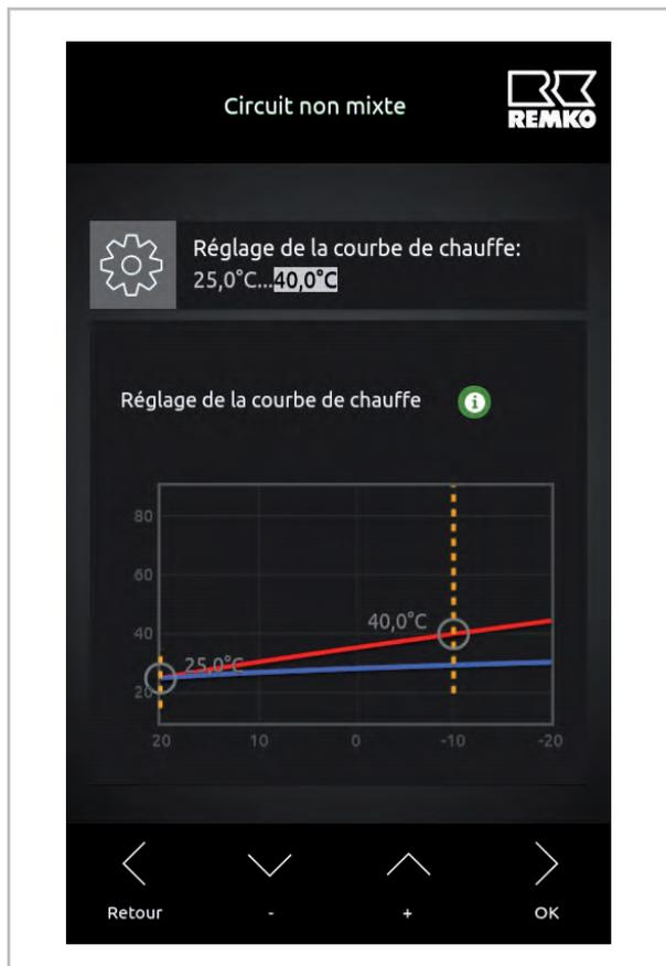
Fig. 7: Réglage de la valeur plancher
