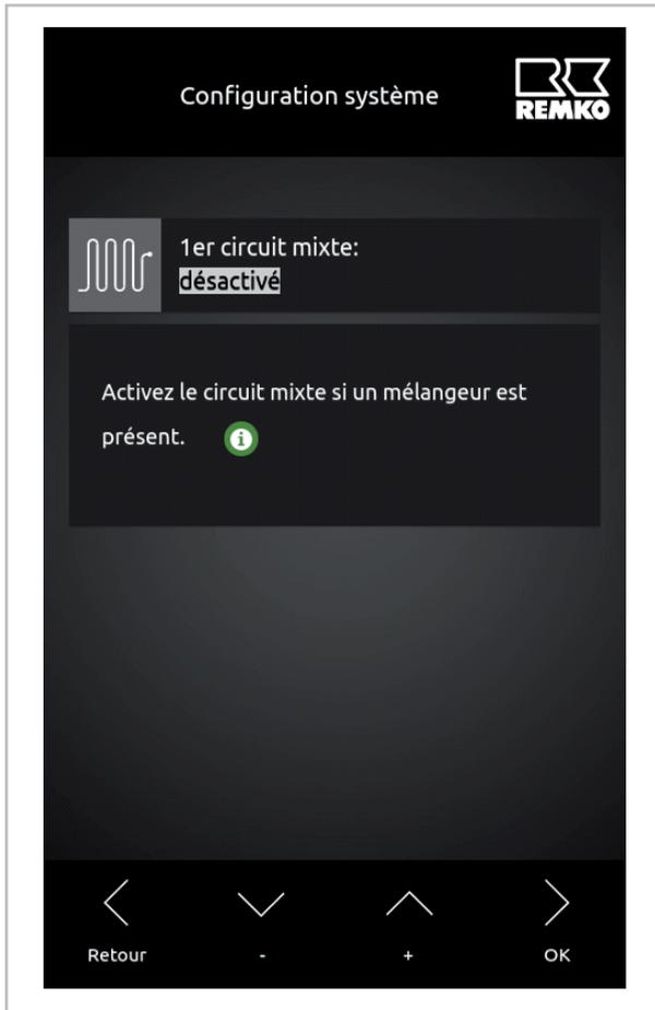
Fig. 51: Activation du circuit de chauffe
