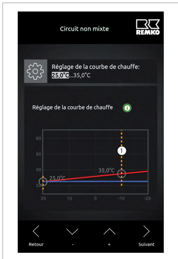
Fig. 9: Réglage de la température extérieure normalisée
