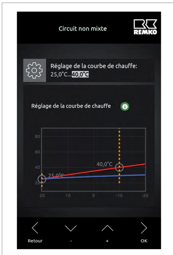
Fig. 8: Réglage de la température aller normalisée
