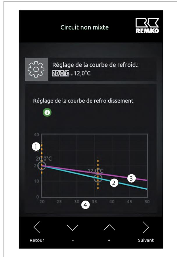
Fig. 11: Réglage de la courbe de refroidissement
