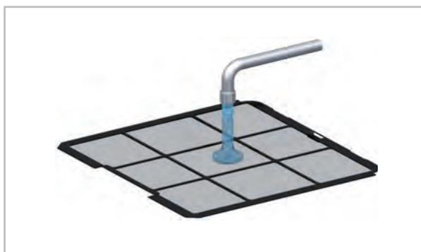
Fig. 20: Nettoyage avec l'eau tiède
