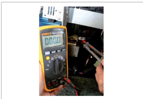
Abb. 42: Messung des Transformators
