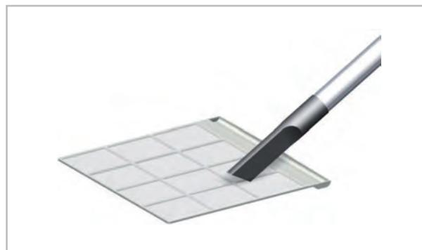
6. ➤ Reinigen Sie dann den großen Luftfilter mit lauwarmen Wasser und milden Reinigungsmitteln. Drehen Sie dazu die verunreinigte Seite nach unten.
