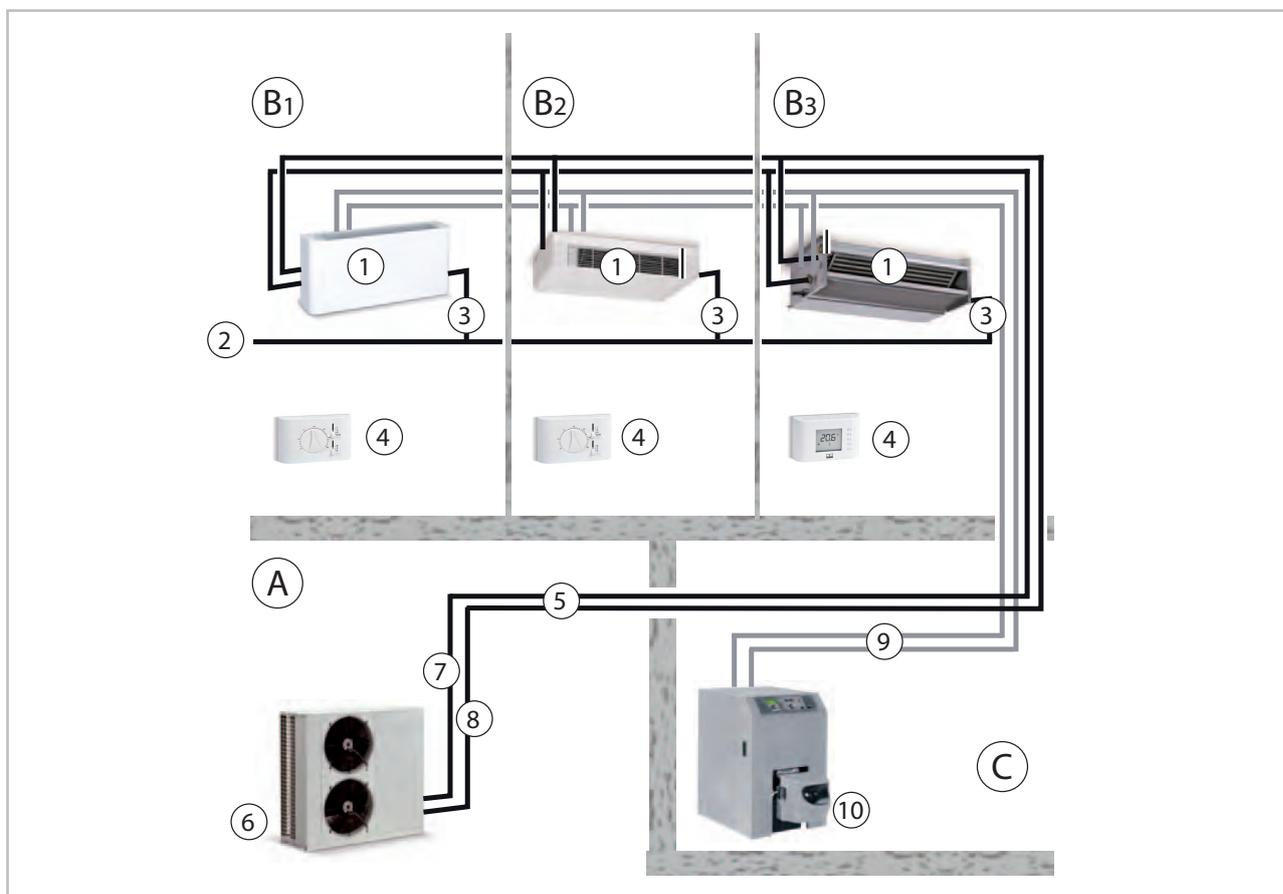
Fig. 6: Exemple d'architecture du système à 4 conducteurs (systèmes de climatisation à eau froide)
