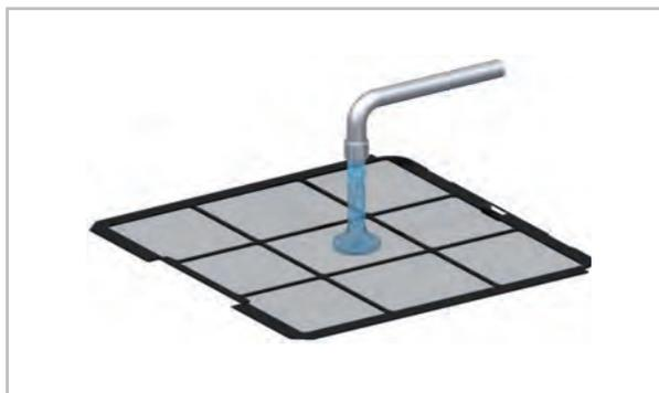
Fig. 20: Nettoyage avec l'eau tiède
