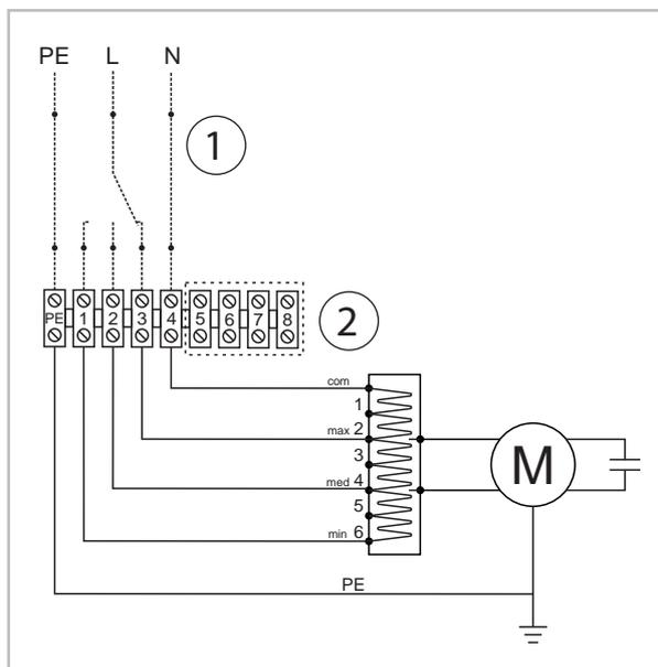
Fig. 17: Schéma de câblage électrique KWK 125 - KWK 725 (DM)
