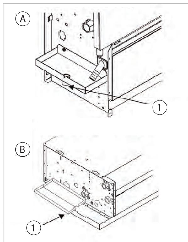
Fig. 15: Raccord pour condensat avec module de vanes
