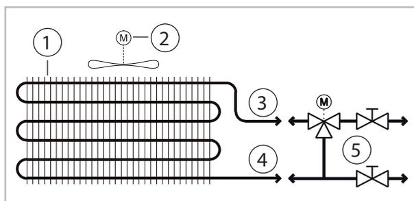
Fig. 3: Schéma du circuit de fluide du système à 2 conducteurs
