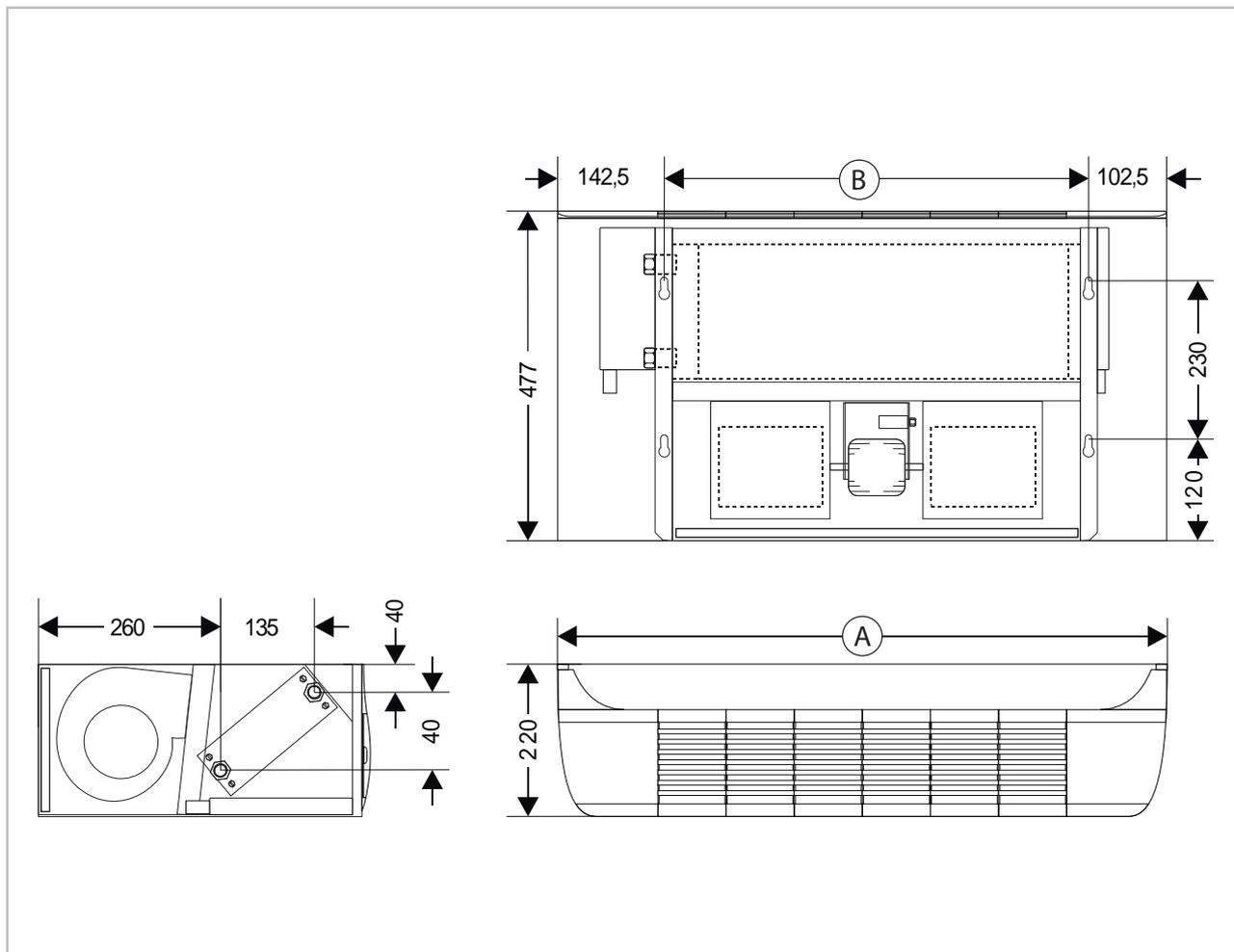
Fig. 2: Dimensions de l'appareil (toutes les indications sont en mm)
