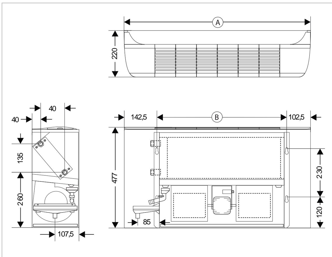
Fig. 1: Dimensions de l'appareil (toutes les indications sont en mm)
