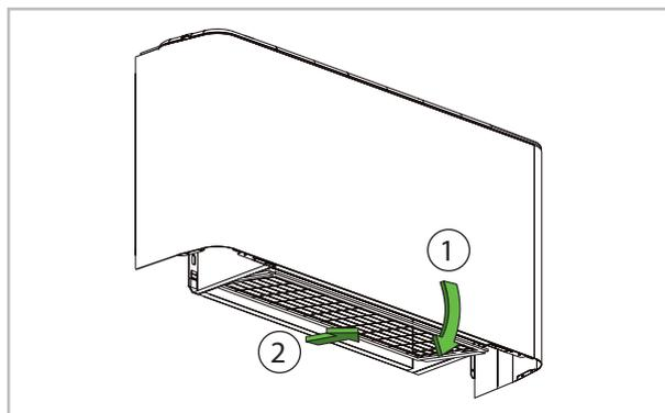
Fig. 18: Dépose du filtre
