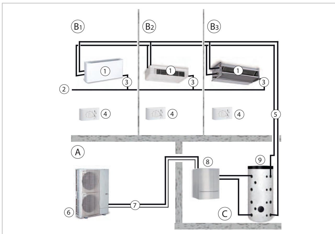
Fig. 5: Exemple d'architecture du système à 2 conducteurs (systèmes de thermopompes)
