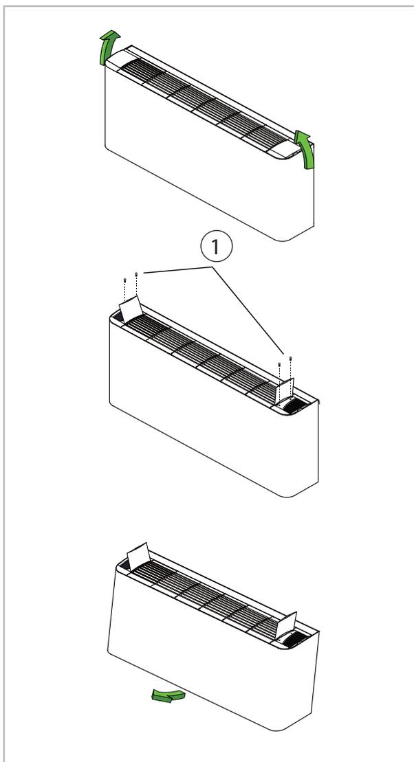
Fig. 21: Démontage du revêtement d'appareil
