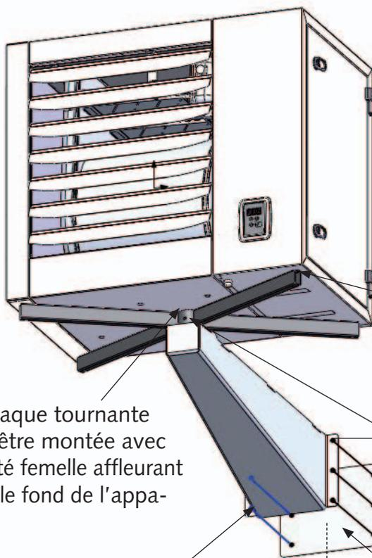
La plaque tournante doit être montée avec le côté femelle affleurant sous le fond de l'appareil.
