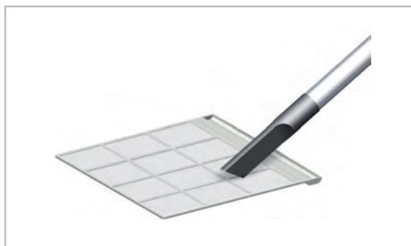
Abb. 36: Reinigung mit dem Staubsauger
