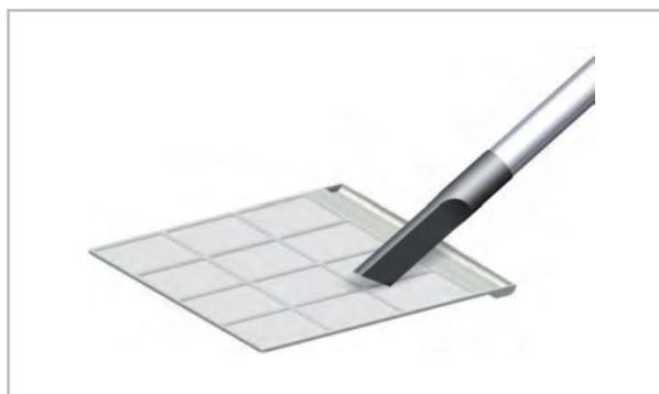
Abb. 60: Reinigung mit dem Staubsauger
