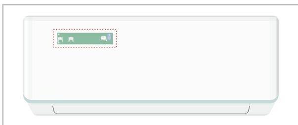
Abb. 32: Eibauposition der Adapterplatine
