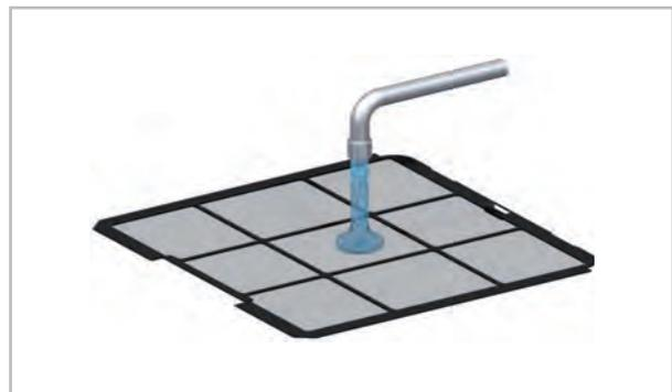
Fig. 59: Nettoyage avec l'eau tiède
