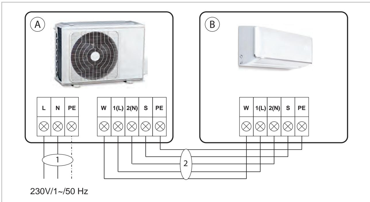
Fig. 39: Schéma de raccordement électrique
