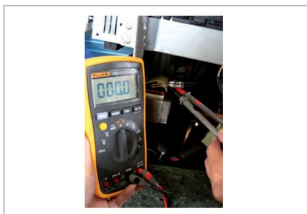
Fig. 53: Mesure du transformateur
