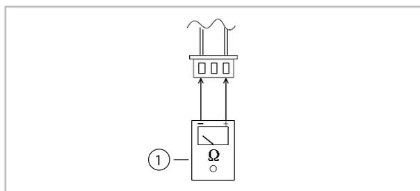
Fig. 56: Vérifier les capteurs de température
