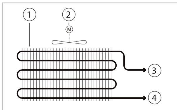
Fig. 3: Schéma du circuit frigorifique de l'unité intérieure
