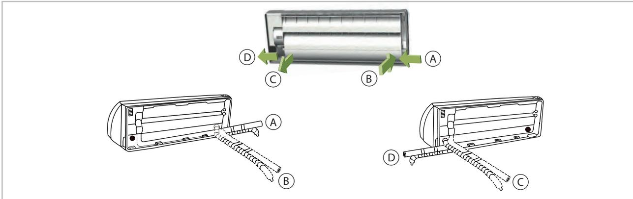
Fig. 26: Variantes de raccordement (vue de derrière)
