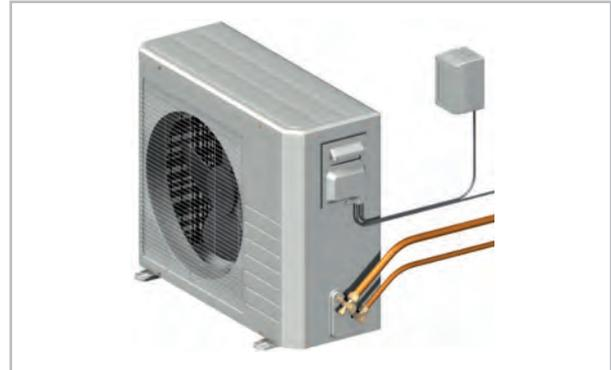
Fig. 38: Raccordement de l'unité extérieure
