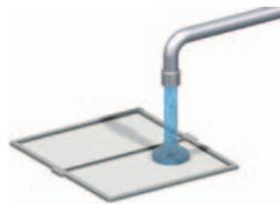
7. Vérifier également le niveau d'encrassement de la grille d'aspiration et la nettoyer au besoin.
