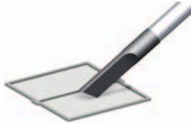
6. En cas d'encrassement important, le filtre peut être rincé avec une solution savonneuse tiède (max. 40 °C). Rincez ensuite impérativement à l'eau claire et laissez sécher !
