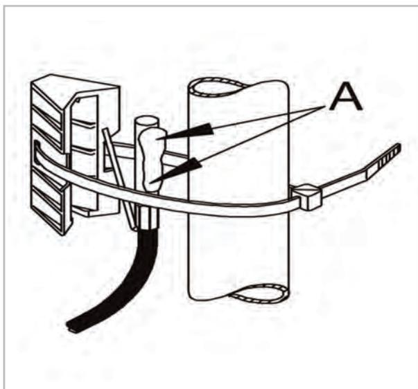
Fig. 10: Fixation de la sonde d'applique
