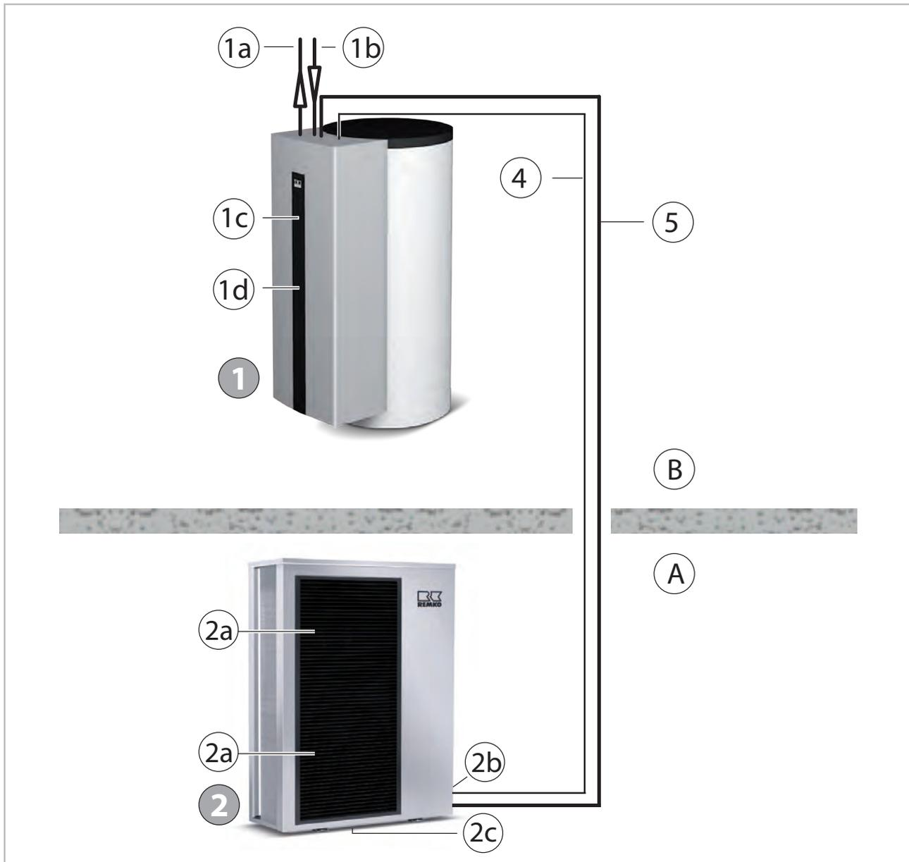
Fig. 3: Architecture du système WKF NEO-compact 170
