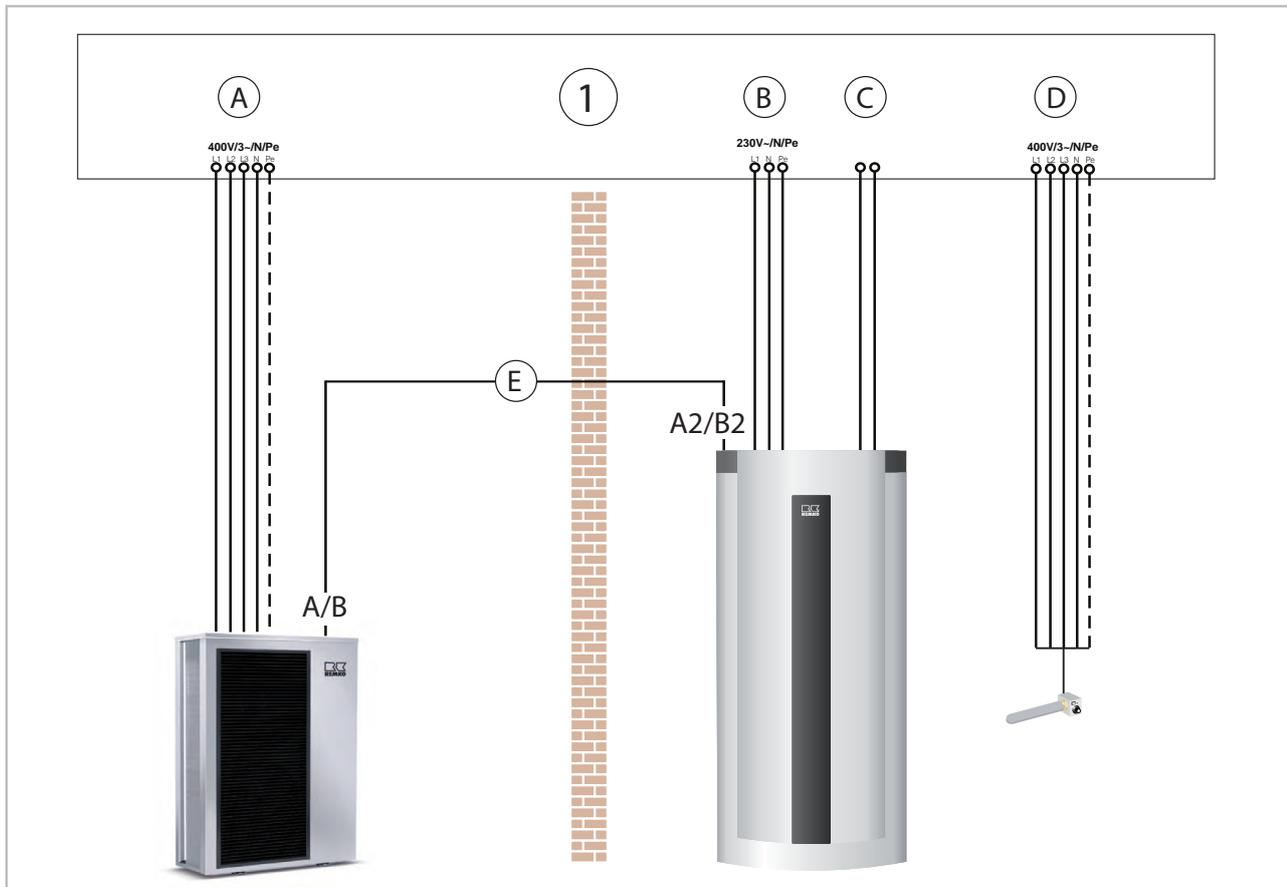
Fig. 5: Aperçu des câbles électriques
