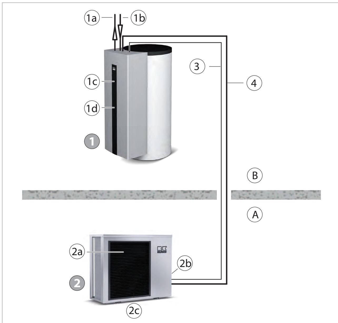
Fig. 2: Architecture du système WKF NEO-compact 100/WKF NEO-compact 130
