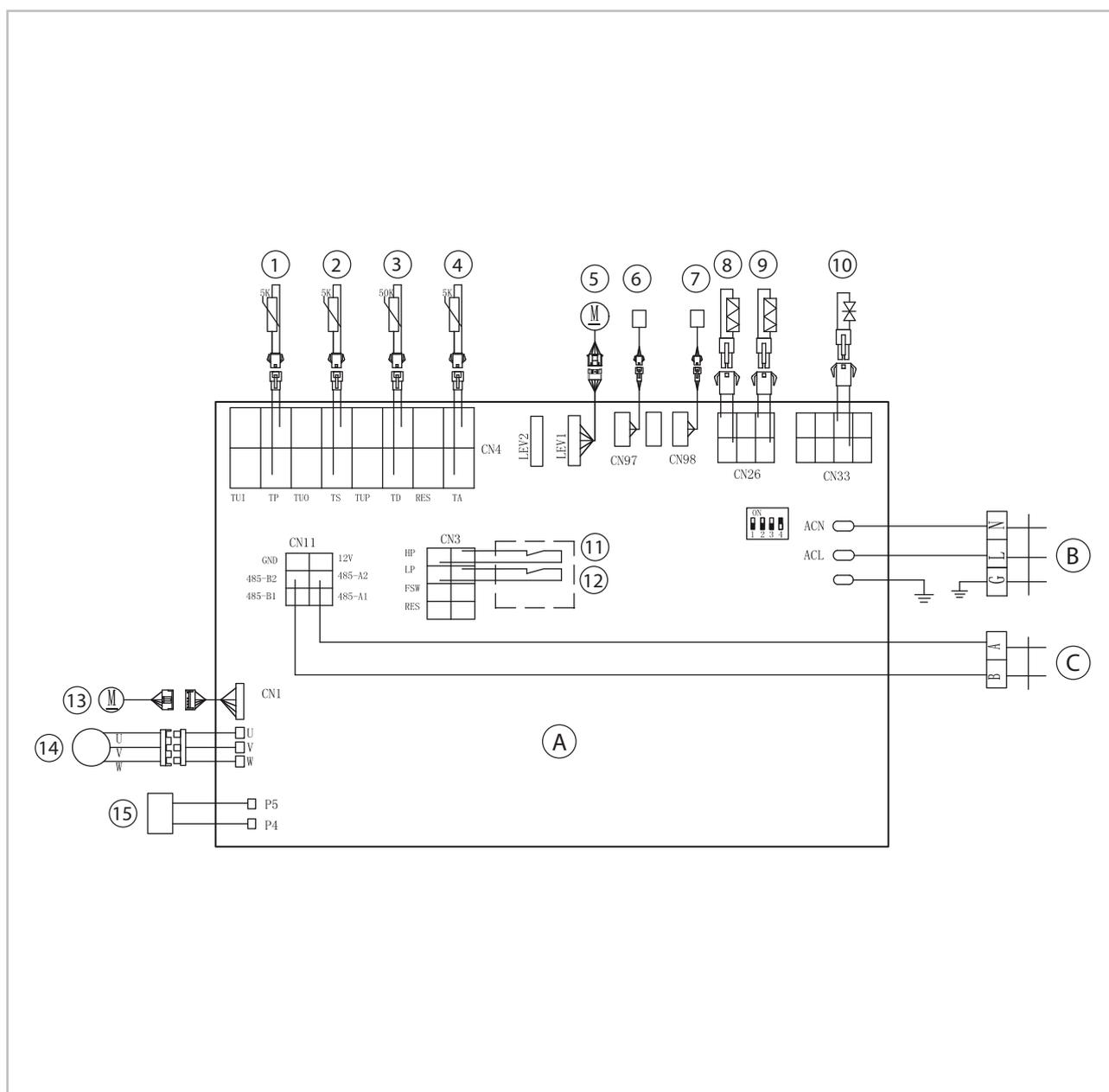
Fig. 12: Schéma de câblage électrique modules externes
