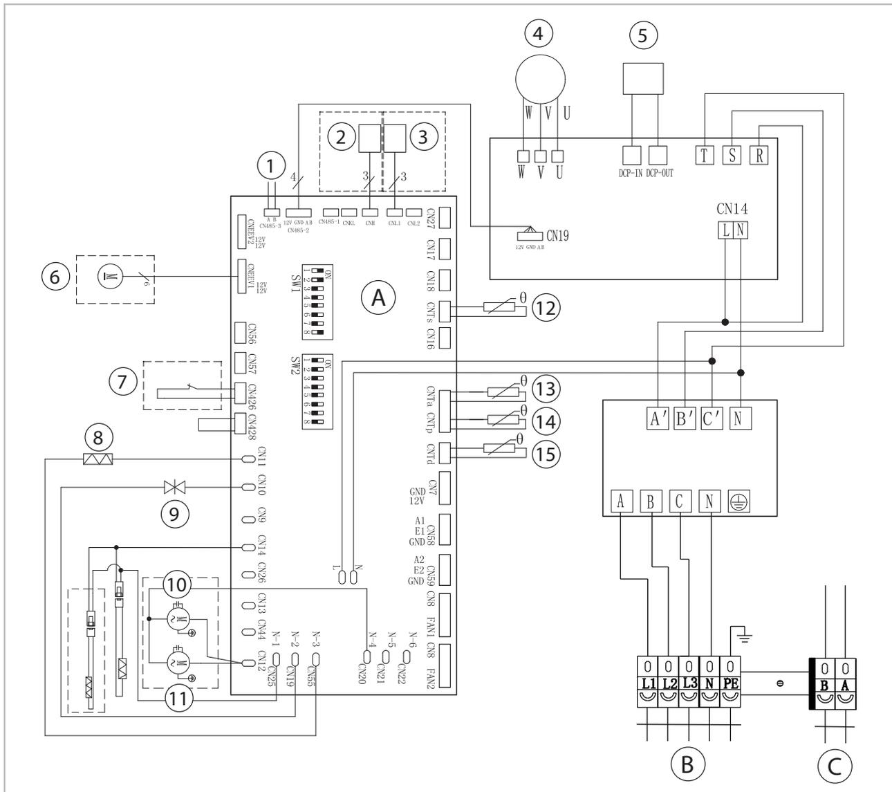
Fig. 13: Schéma de câblage électrique modules externes
